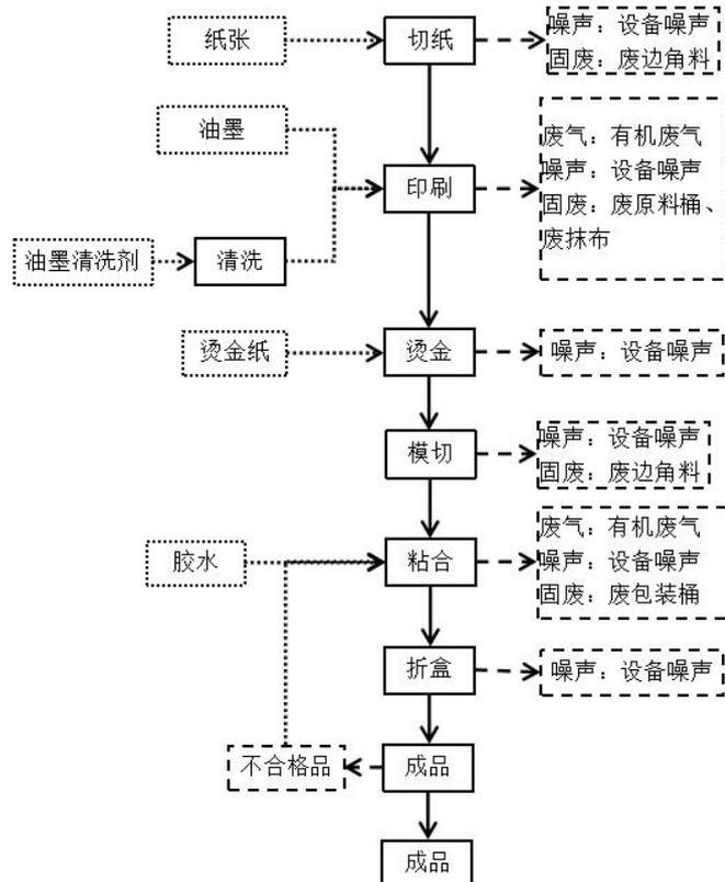
图 2 项目化妆品包装盒、药品包装盒生产工艺流程图
