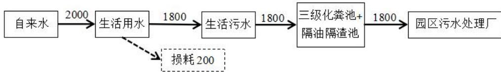
图 1 项目水平衡图（单位：m³/a）
