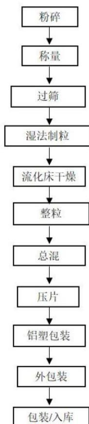
图 6 项目阿伐那非片生产工艺流程图
