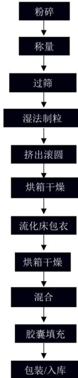
图 2 项目盐酸地尔硫卓控释胶囊生产工艺流程图
