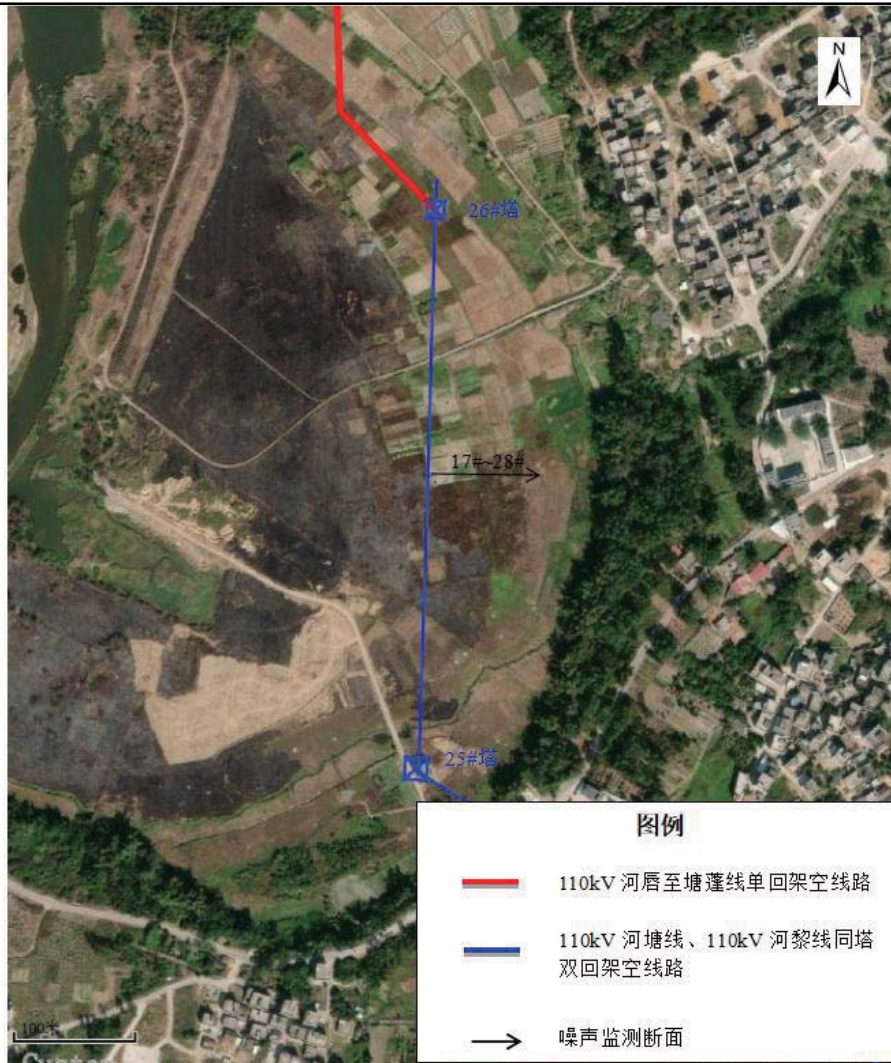
图 4.2-2 湛江 110kV 河塘线、110kV 河黎线同塔双回架空线路布点示意图
